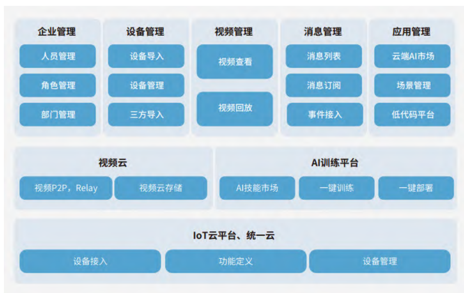
图 360 视觉云 SaaS 平台技术架构
